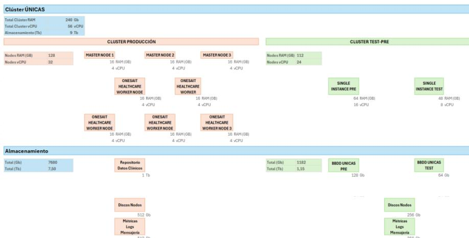
El escenario mediano ofrece una configuración equilibrada para CCAA con cargas intermedias. Se contempla un clúster de producción con 3 nodos *master* y entre 3 y 4 nodos *worker*. Para el entorno de test-preproducción, se recomienda una arquitectura en modo instancia única, suficiente para validar flujos y realizar pruebas funcionales, manteniendo controlado el consumo de recursos.
